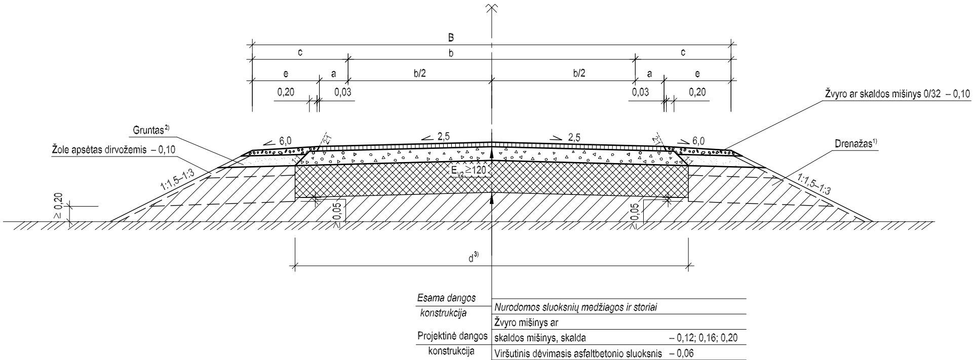
**PASTABA:** Ev<sub>2</sub> reikšmės nurodytos MPa<sup>1)</sup> pagrindžiami drenažo poreikis ir tipas<sup>2)</sup> ŽB, ŽG, ŽP, SB, SG, SP, ŽD, ŽM, SD, SM<sup>3)</sup> nustatoma pagal tyrimų (tyrinėjimų) duomenis
