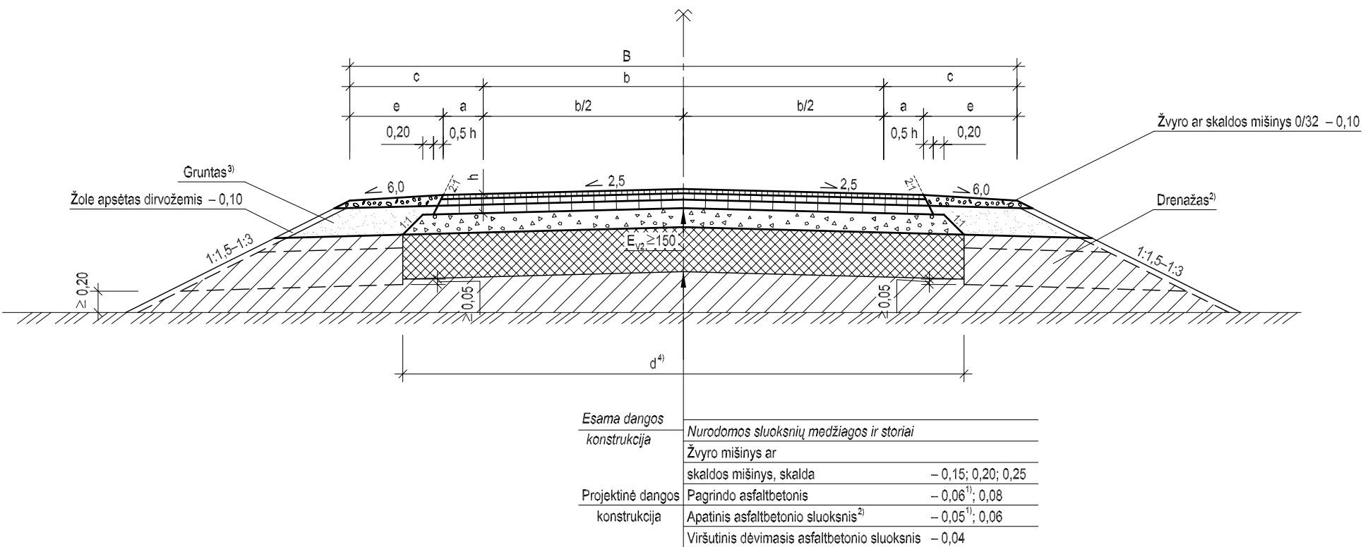
**PASTABA:**  $E_{v2}$  reikšmės nurodytos MPa<sup>1)</sup> taikoma III dangos konstrukcijos klasėi<sup>2)</sup> pagrindžiami drenažo poreikis ir tipas<sup>3)</sup> ŽB, ŽG, ŽP, SB, SG, SP, ŽD, ŽM, SD, SM<sup>4)</sup> nustatoma pagal tyrimų (tyrinėjimų) duomenis
